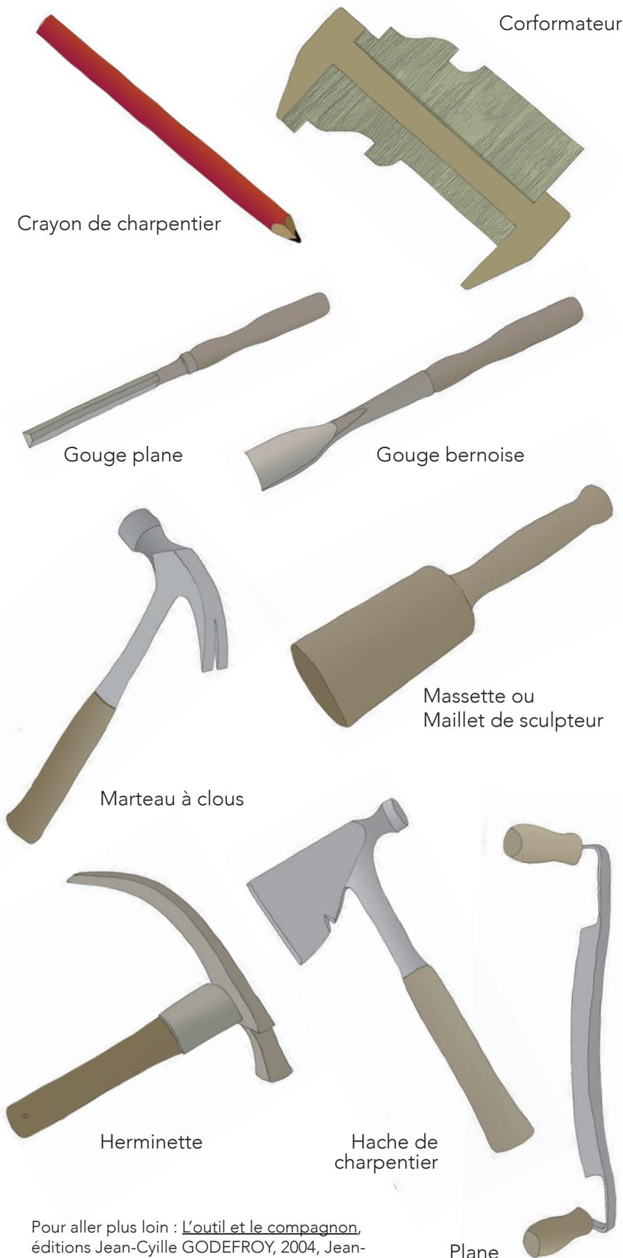
Le menuisier et le charpentier disposent d'outils spécifiquement adaptés au travail du bois (la gouge, l'herminette, le marteau à clous...) et d'autres qui peuvent être communs avec divers corps de métiers (le mètre, le niveau, le confortateur...)
