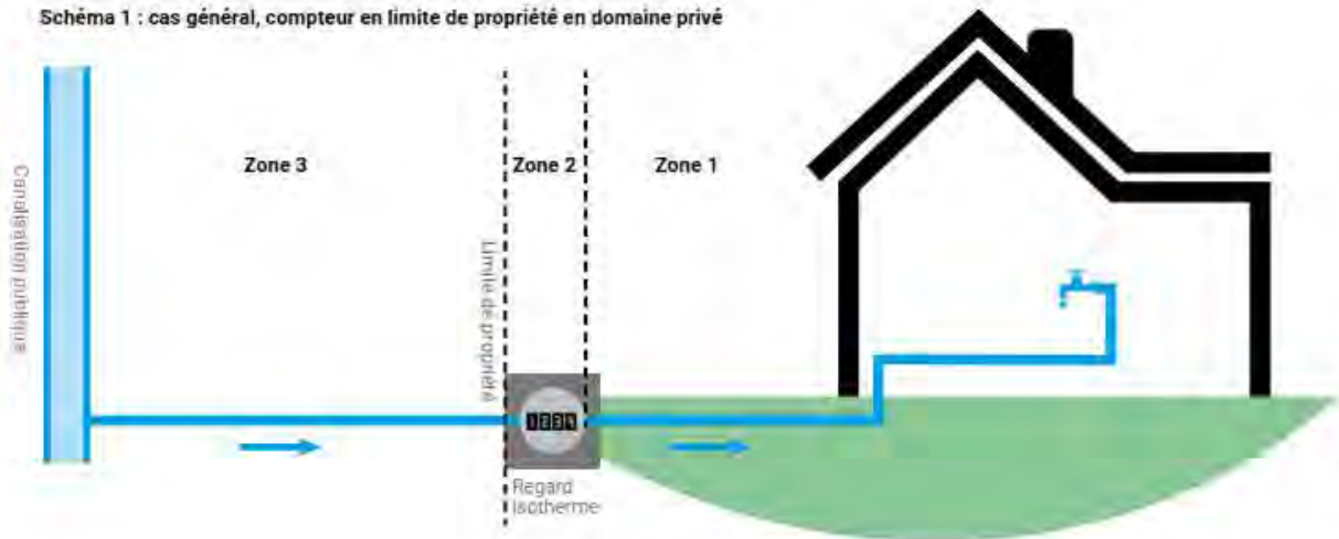
Schéma 1 : cas général, compteur en limite de propriété en domaine privé
