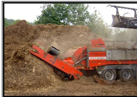
*Broyeur équipé d'un overband (déferrailleur) sur le tapis d'évacuation*
